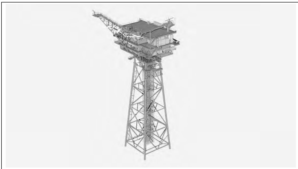
รูปที่ 2-4: ภาพจำลองแสดงองค์ประกอบของแท่นหลุมผลิต (Wellhead Platform)
