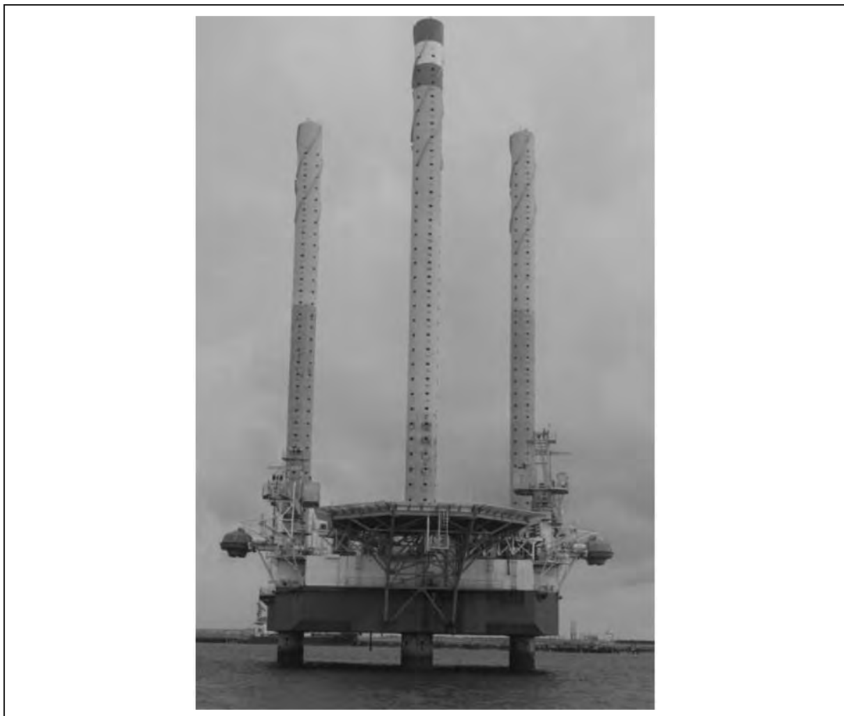
รูปที่ 2-3: ตัวอย่างแท่นผลิตแบบเคลื่อนย้ายตำแหน่งได้ (MOPU)
