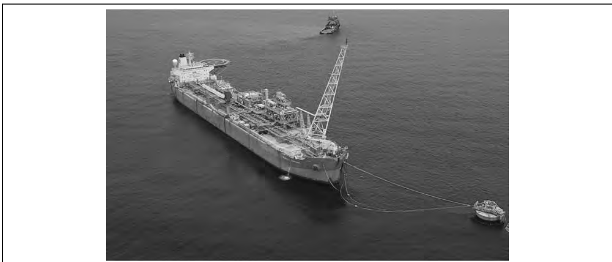
รูปที่ 2-12: ภาพตัวอย่างของเรือกักเก็บปิโตรเลียมที่ผูกยึดกับระบบยึดโยงแล้ว
